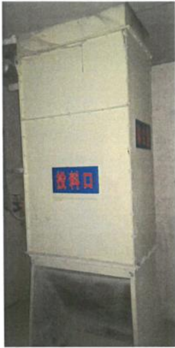
投料口袋式除尘器
