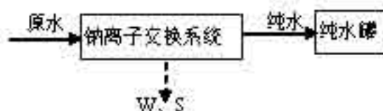
图 2.2-5 纯水制备工艺流程及产污环节图
