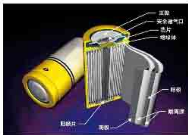
图 2.2-2 锂离子电池结构示意图
