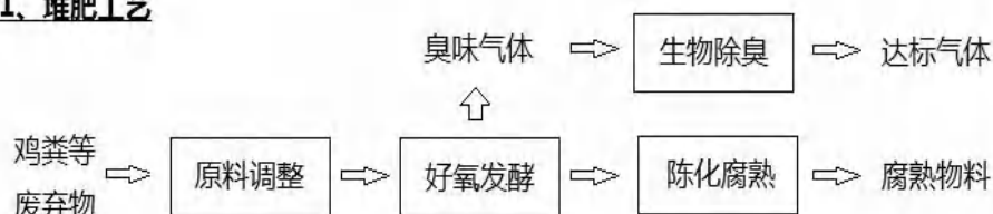
图 5.4-1 堆肥工艺流程图
